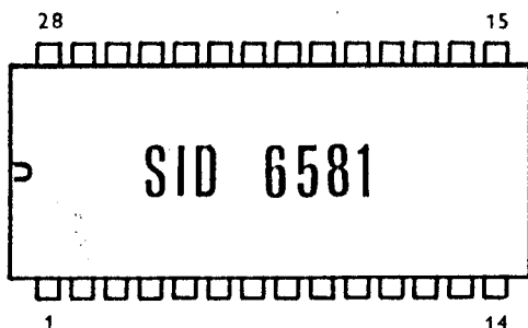
Obr.1 Zapojení pouzdra SID 6581
